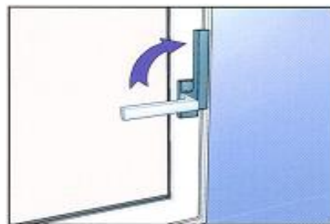
Når rammen presses mot karmen og håndtaket dreies 90 grader opp kan rammen åpnes sideveis.
